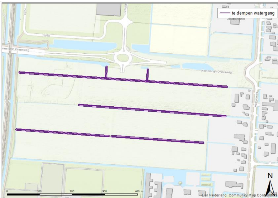
Figuur 8 Te dempen schouwsloten
