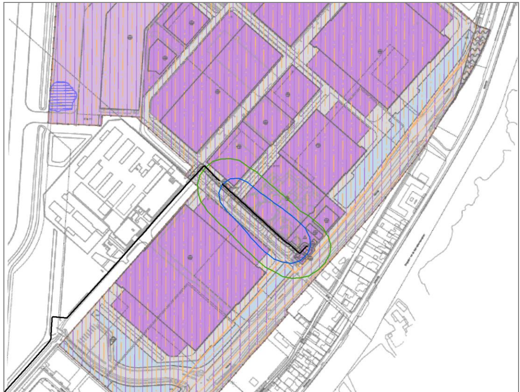
Figuur 4. Plaatsgebonden risicocontouren aardgasleiding W-529-12
