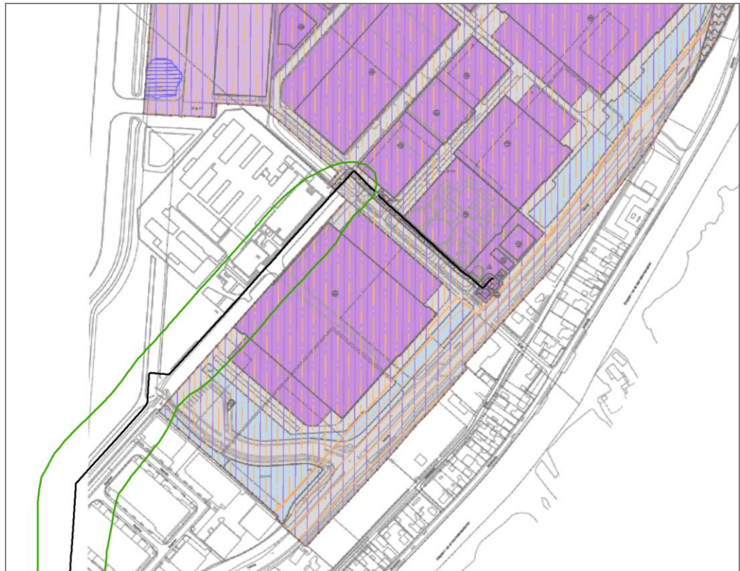
Figuur 3. Plaatsgebonden risicocontouren aardgasleiding W-529-09
