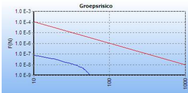
Figuur 5.2 FN curve voor W-529-09 van N.V. Nederlandse Gasunie voor de kilometer tussen stationing 2620.00 en stationing 3620.00
