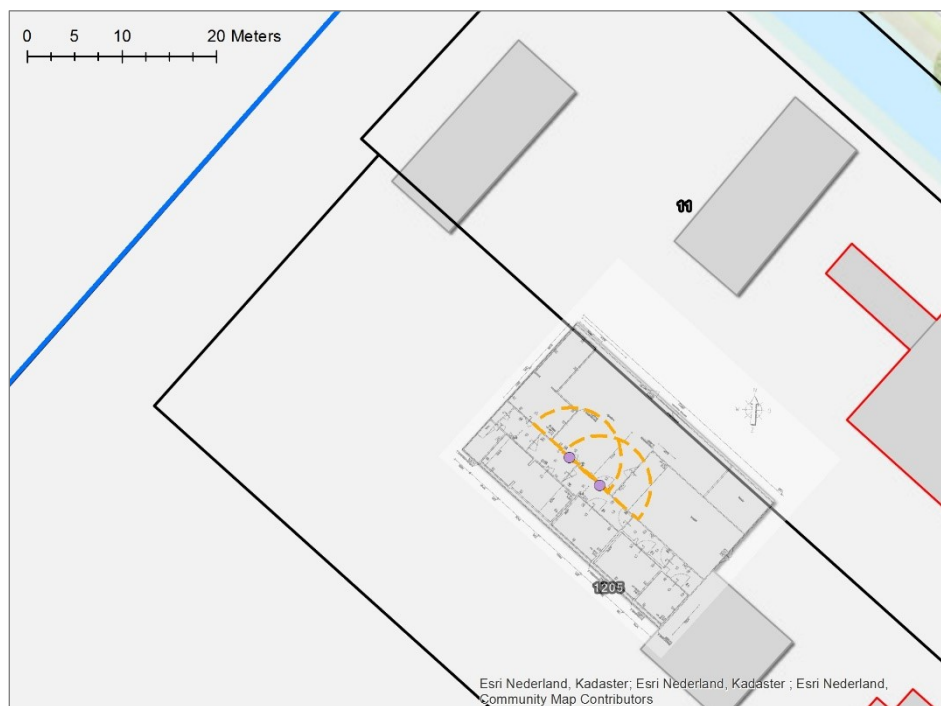
Figuur 5. Contour 10 kW/m 2 (oranje stippellijn) vanaf midden deur 2 en 3
