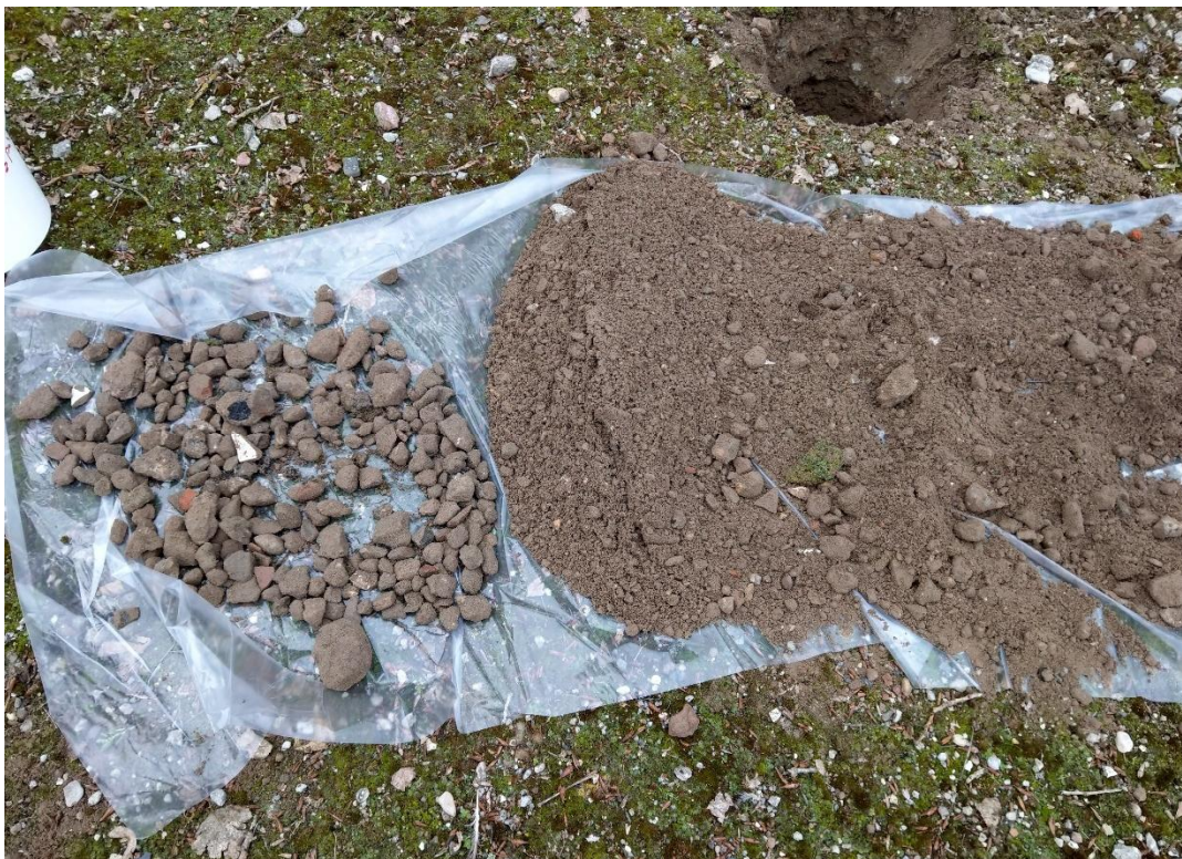
Repac van halfverhardingslaag uitgezeefd
