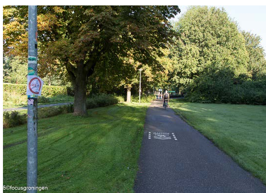
Figuur 4.1 Voorbeelden van lijnvormige verharding en alternatieve berging zoals bedoeld door gemeente Haarlemmermeer. Links: lijnvormige verharding waarbij het hemelwater niet versneld wordt afgevoerd door riolering of die niet direct afstroomt naar oppervlaktewater. Rechts: watervertragende groenstrook als vorm van alternatieve waterberging.
