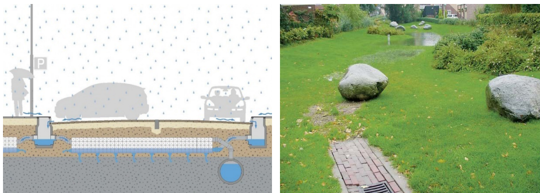
Figuur 4.2 Voorbeelden van verharding en alternatieve berging zoals bedoeld door gemeente Haarlemmermeer. Links: Wadi als alternatieve waterberging. Rechts: Waterbuffer onder rijbaan als voorbeeld van alternatieve waterberging.
