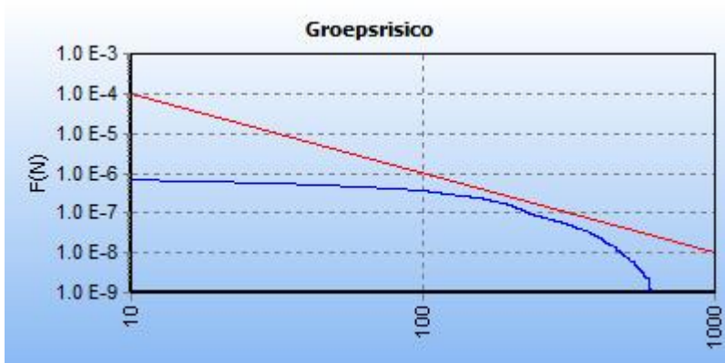
Figuur 5.1 FN curve voor 5445_leiding-W-532-01-deel-1 van N.V. Nederlandse Gasunie voor de kilometer tussen stationing 6540.00 en stationing 7540.00
