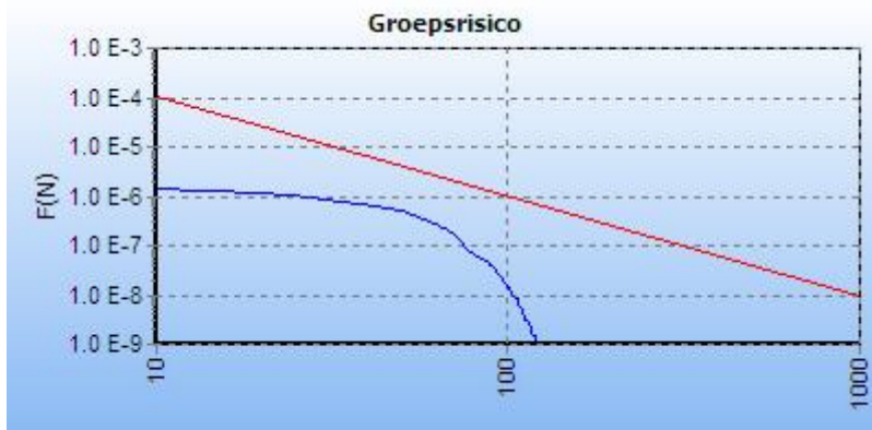
Figuur 12. GR-curve 2: leiding W-532-01 stationing 4700 - 5700
