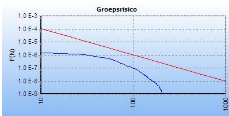
Figuur 14. GR-curve 4: leiding W-532-01 stationing 7100 - 8100
