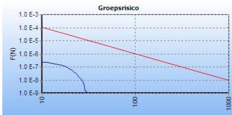
Figuur 17. GR-curve 7: leiding W-532-06 stationing 0 - 560
