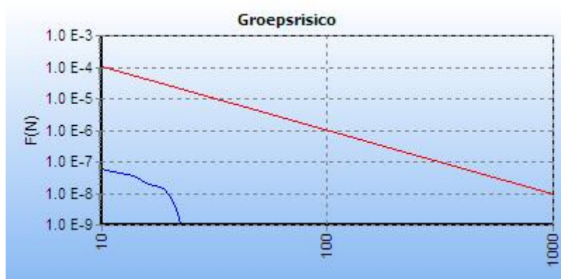
Figuur 16. GR-curve 6: leiding W-532-01 stationing 9700 - 10700
