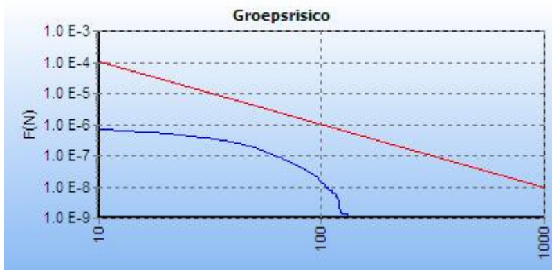
Figuur 13. GR-curve 3: leiding W-532-01 stationing 5800 - 6800
