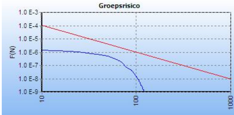
Figuur 12. GR-curve 2: leiding W-532-01 stationing 4700 - 5700
