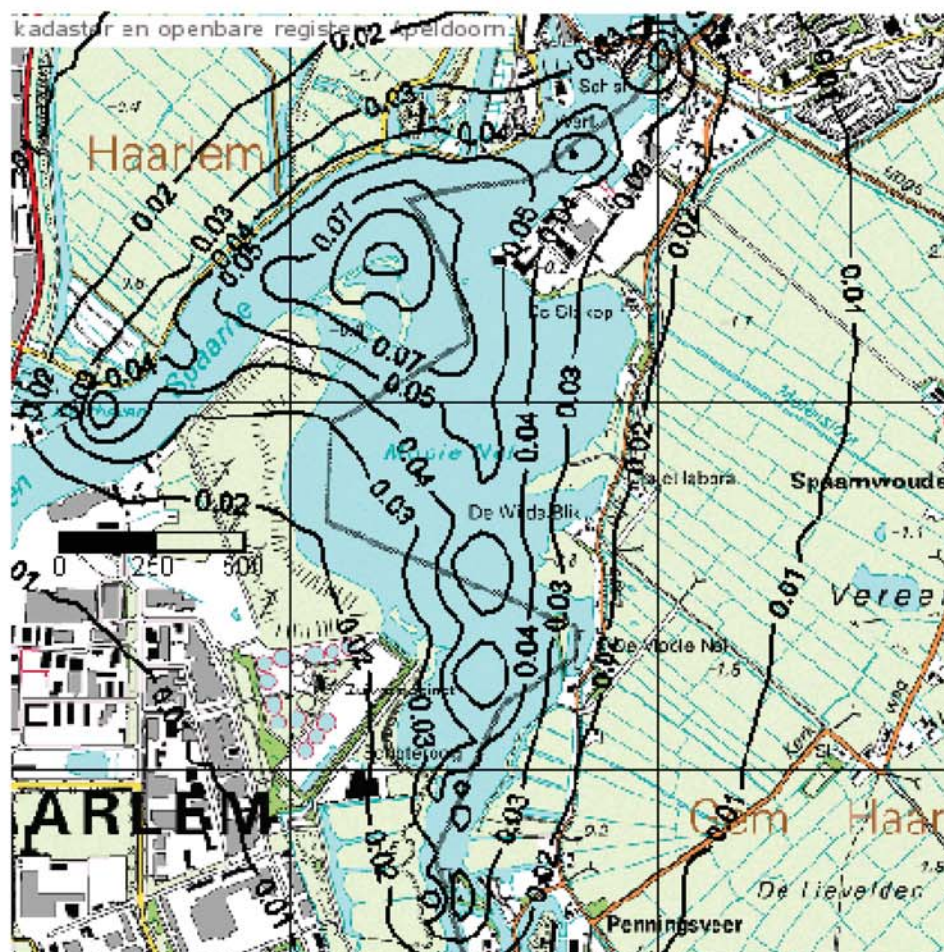
Figuur 4.2 Jaargemiddelde bronbijdrage van de scheepvaart voor de component NO 2 (de binnenste contouren betreffen respectievelijk 0,10 en 0,15)
