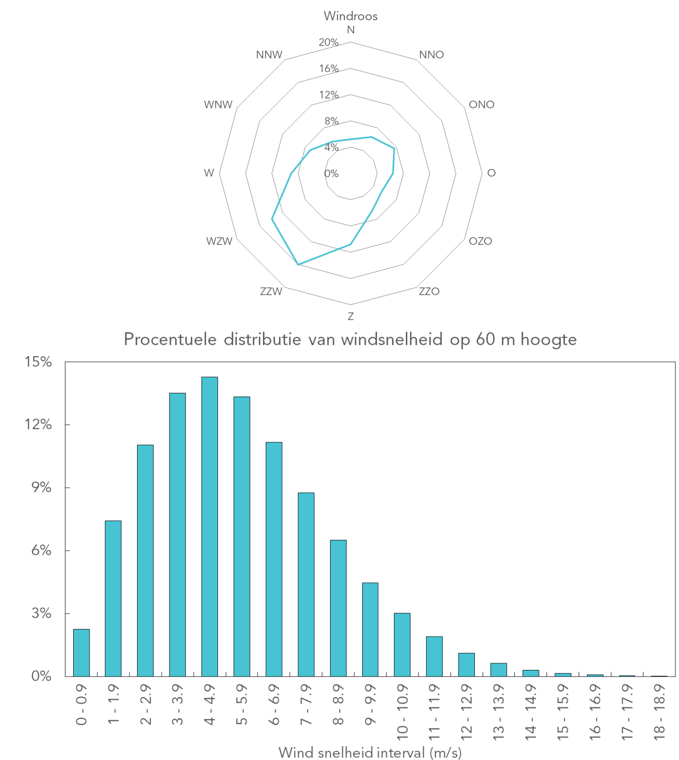
— Figuur 3.5: Visualisatie van de windstatistiek welke is gebruikt bij de bepaling van windhinder en windgevaar
