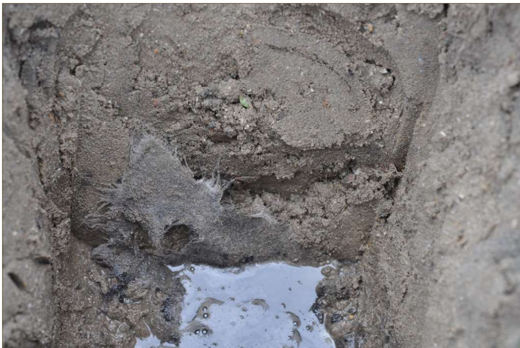
Afbeelding 12: Detail boring 12A. Het doek (vrijwel dezelfde kleur als het zand) is zichtbaar boven het grondwater
