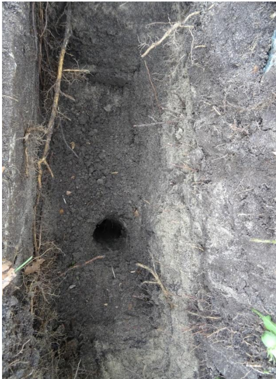
In sleuf B is de wortelgroei tot 40 cm-mv matig intensief. Links is de oude fundering zichtbaar.
