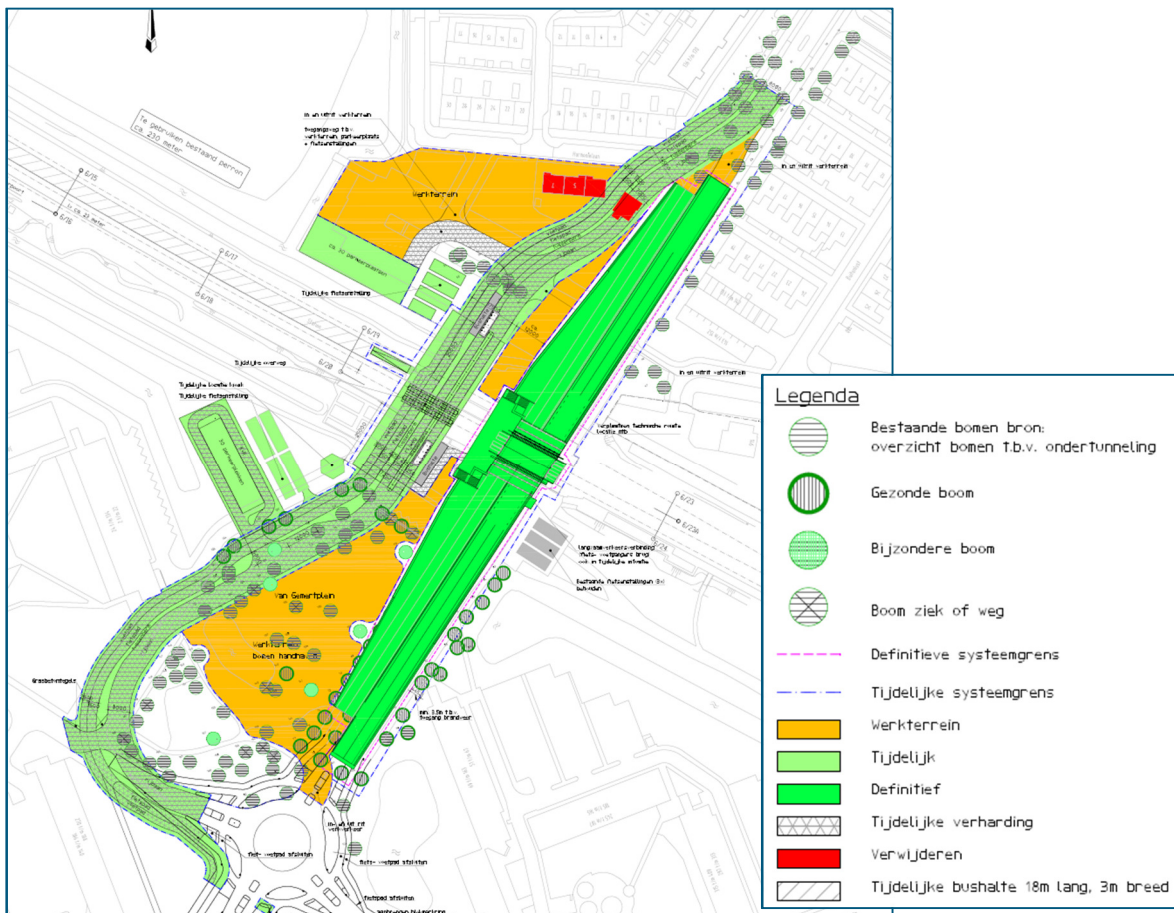
Figuur 2-3: Tekening van de situatie tijdens aanleg van de spooronderdoorgang.
