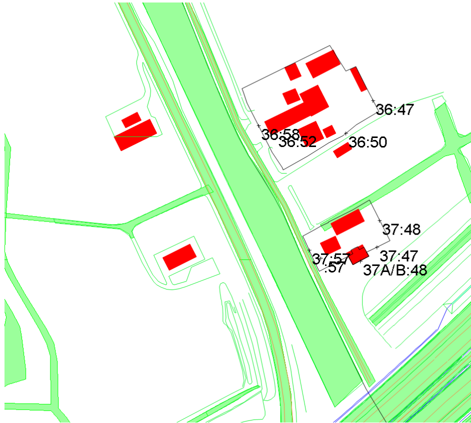
Figuur 9: Huisnummer wijzigingspercelen met Lden Rijkswegen Stammerdijk na aftrek 2 dB, ex. artikel 110g van de Wet geluidhinder (7,5 m boven maaiveld)
