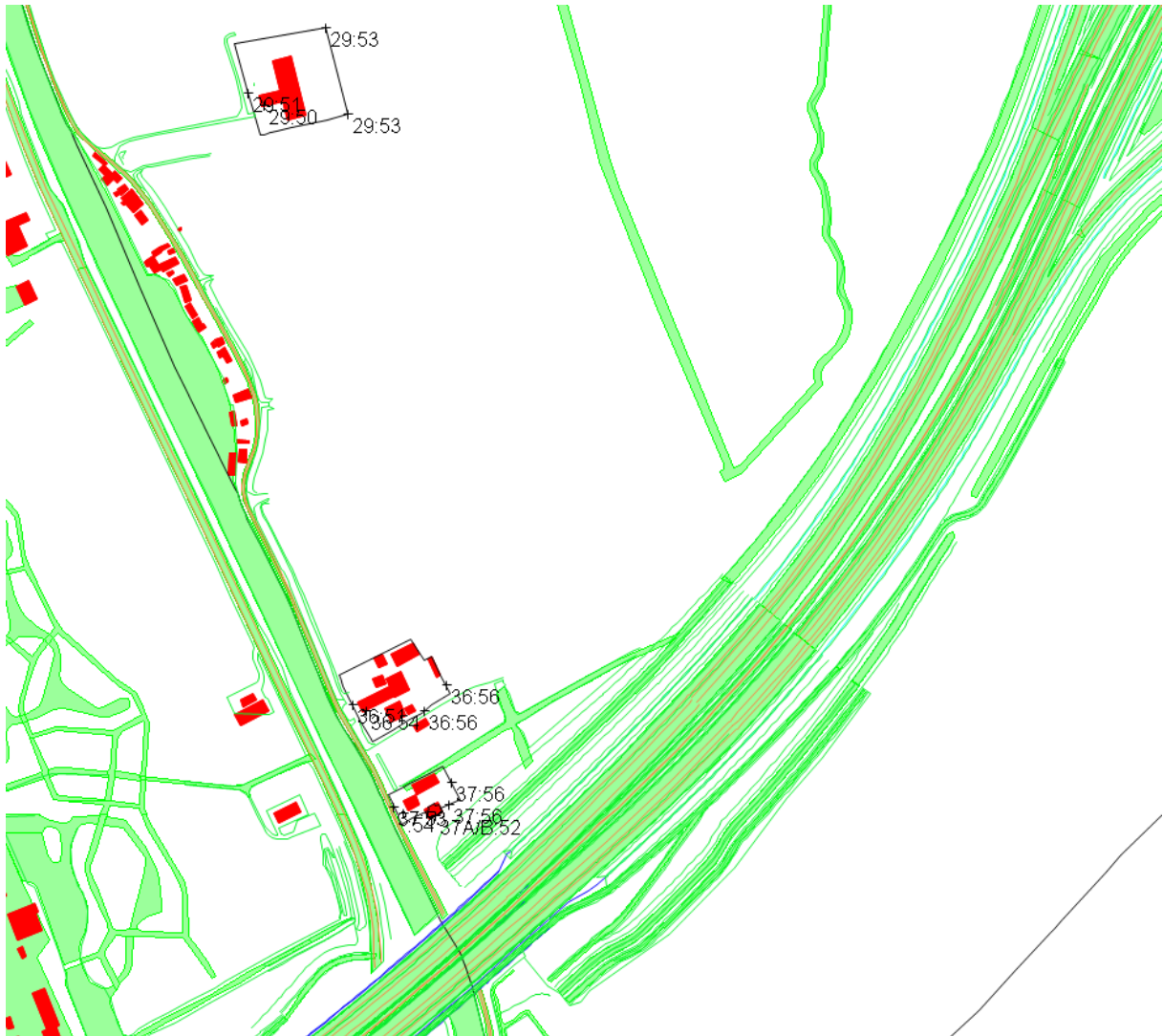
Figuur 8: Huisnummer wijzigingspercelen Stammerdijk met Lden Rijkswegen na aftrek 2 dB, ex. artikel 110g van de Wet geluidhinder ( 7,5 m boven maaiveld)
