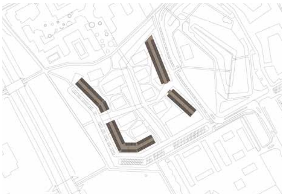
Parkeren onder de woonblokken
