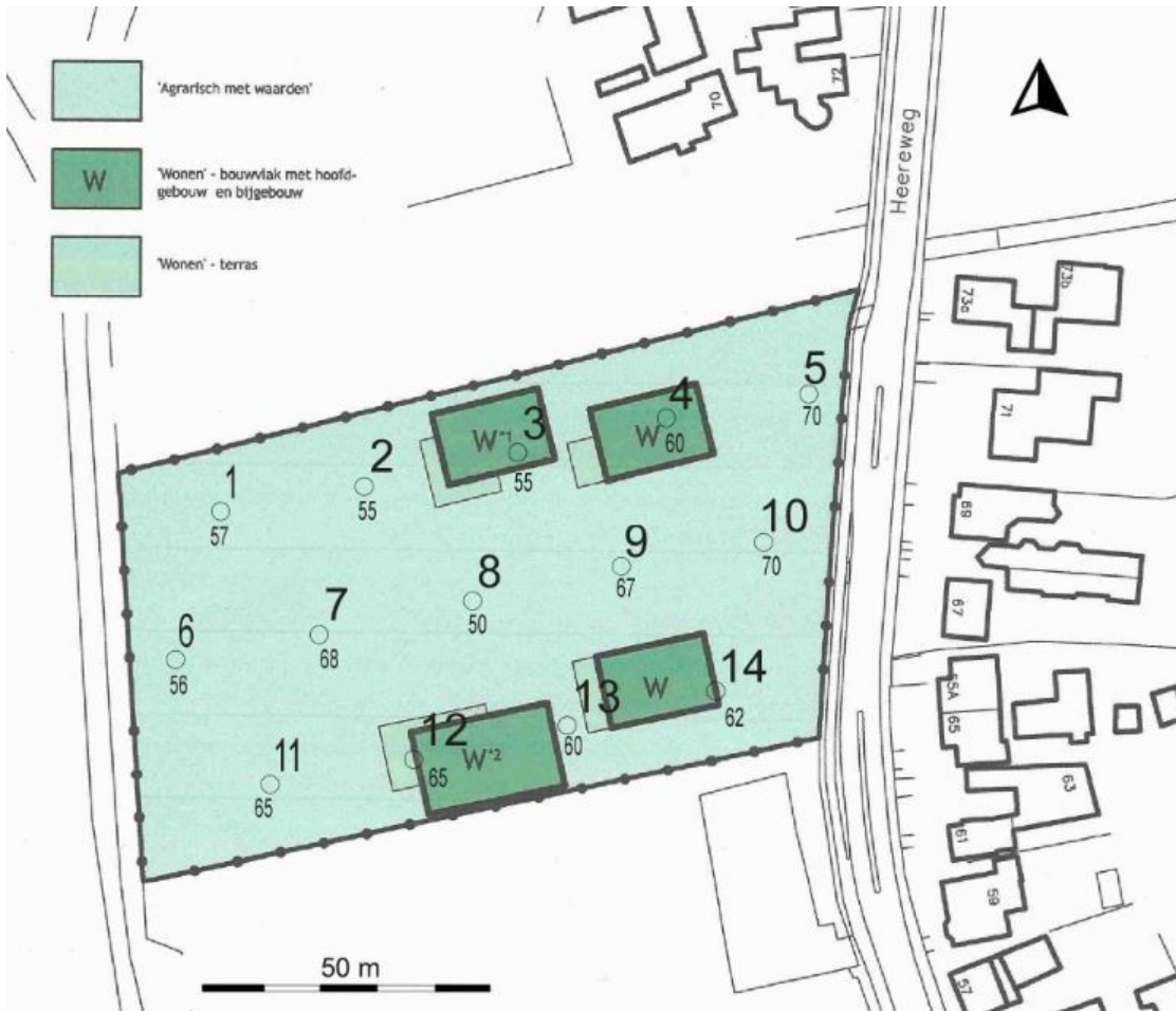
Figuur 4. Bakkum, Heereweg. Boorpuntenkaart; hierop zijn de toekomstige woningbouwlocaties te zien. Per boorpunt is in centimeters beneden het maaiveld aangegeven tot welke diepte de bodem is verstoord [Bron: BügelHajema adviseurs bv].
