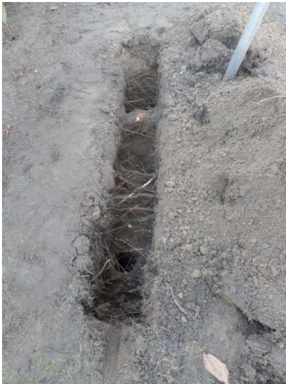
Profielsleuf met beworteling
