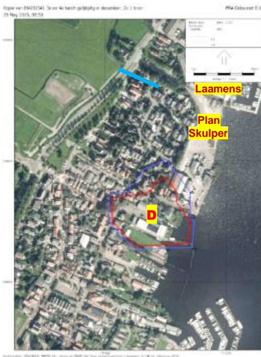
Figuur b: Geurcontouren van 0,5 ouj(H)/m³ als 98 percentielwaarde (blauw) en 1 ouj(H)/m³ als 98 percentielwaarde (rood) als gevolg van de geuremissie van DilVis
