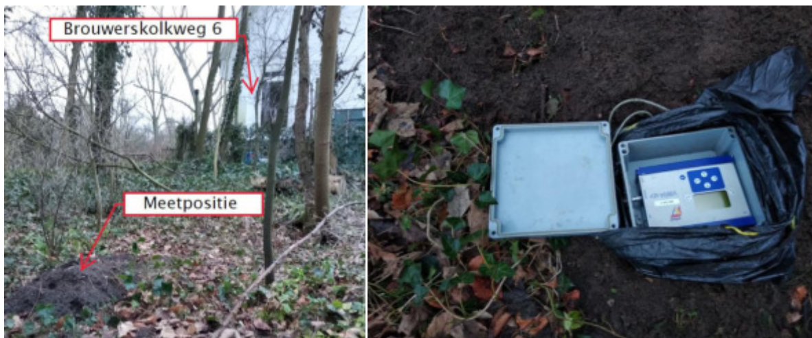
Figuur 3 en 4: foto's van de meetpositie en de trillingsmeter.
