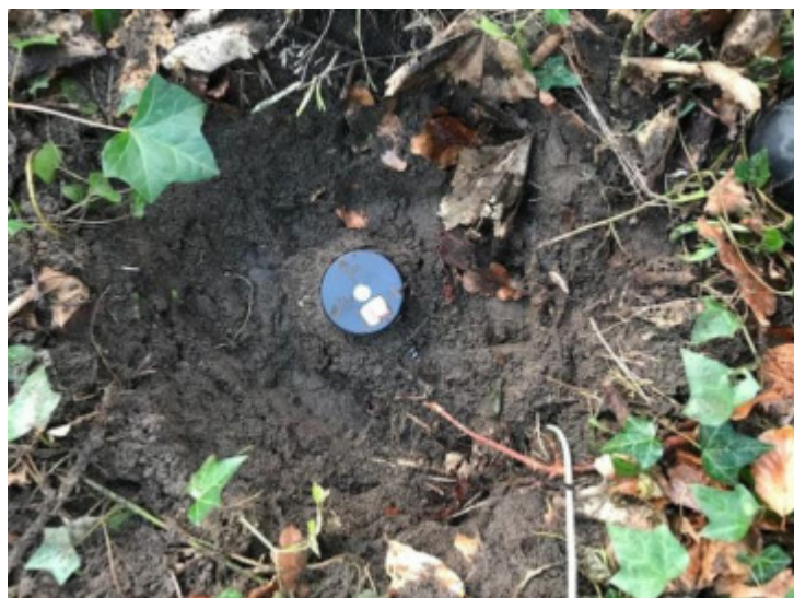
Figuur 5: foto van de ondergrondse positie van de gefoon.
