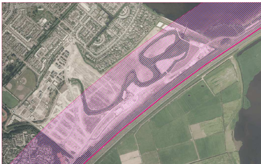
Figuur 2.1: Impressie van de geluidszone van de Rijksweg A27 (400 m)
