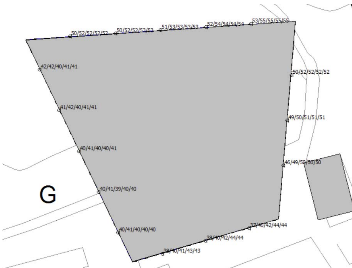
Figuur 4.1: Geluidsbelasting als gevolg van het verkeer op de Koninginneweg/Bergerweg – noordoostelijk blok
