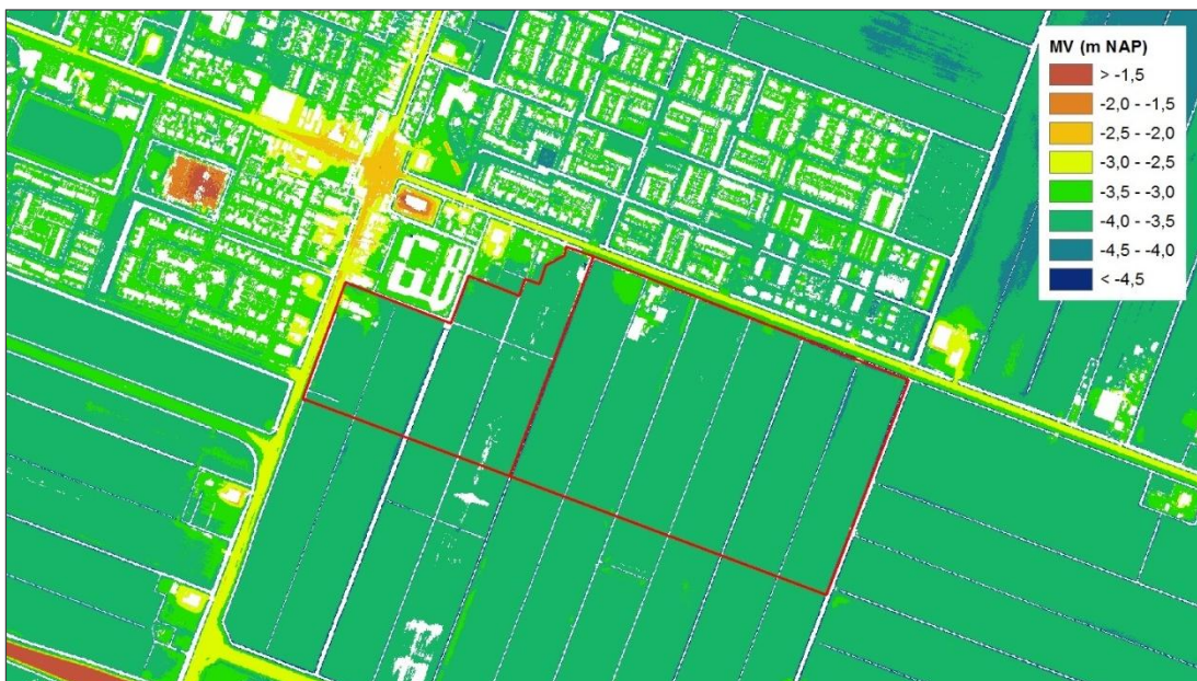
Figuur 3: Hoogteligging maaiveld (hoogtegegevens AHN 2)
