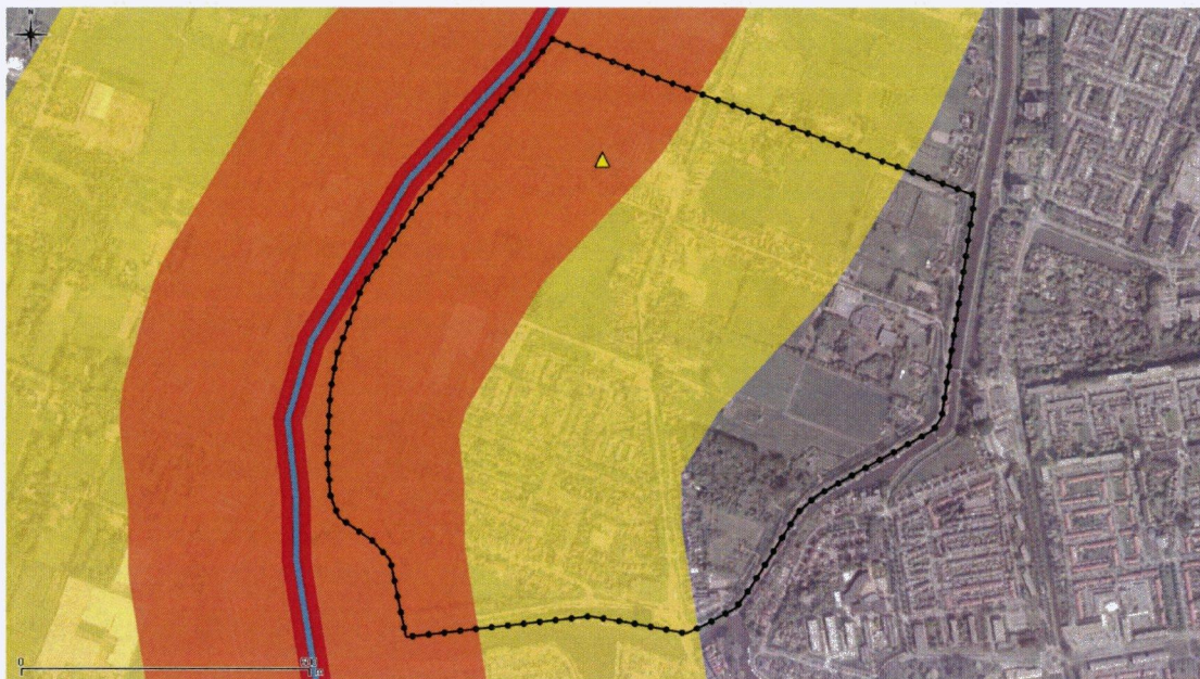
Figuur 4: Effectafstanden toxische wolk [8], met voorbeeldstof acrylnitril
