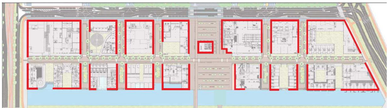
Figuur 5: Gevels die afwateren op het omliggende openbare maaiveld
