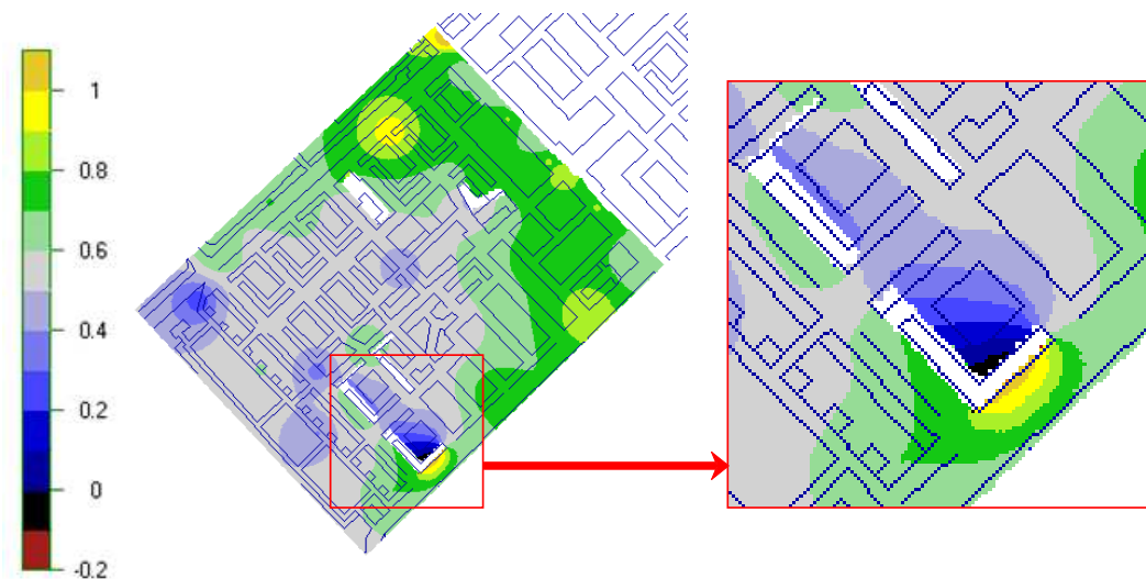
Figuur 10: berekende ontwatering op basis van geschatte GHG en berekend effect van de kelders na maatgevende bui, uitgaande van een gemiddelde maaiveldhoogte van NAP - 3,75 m
