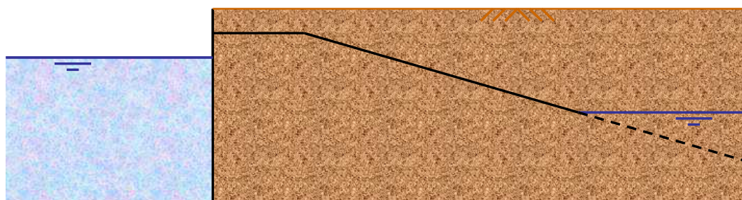
Figuur 10: Doorsnede verholen waterkering
