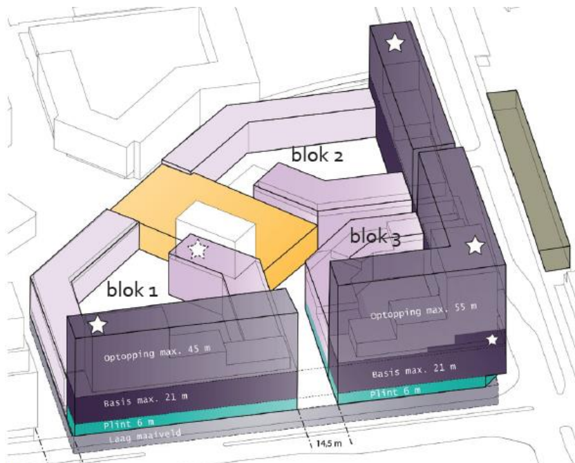
Figuur 2.5 Opbouw bouwblokken (hoogtes t.o.v. winkelniveau)
