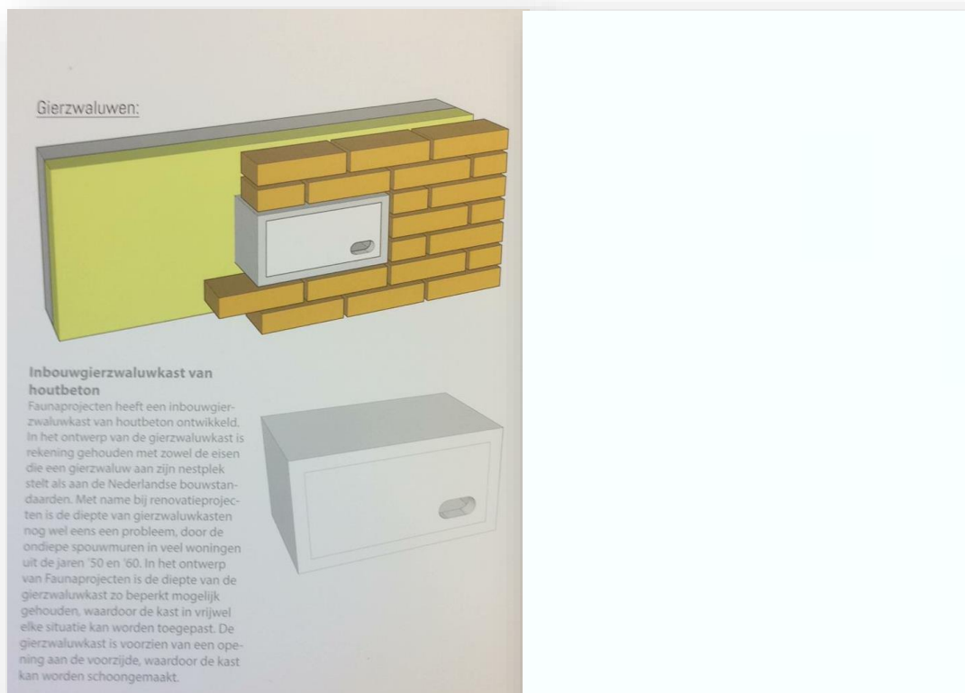
Figuur 11. Voorbeeld inbouwkast en ophang kast gierzwaluw, bron; faunaprojecten.nl
