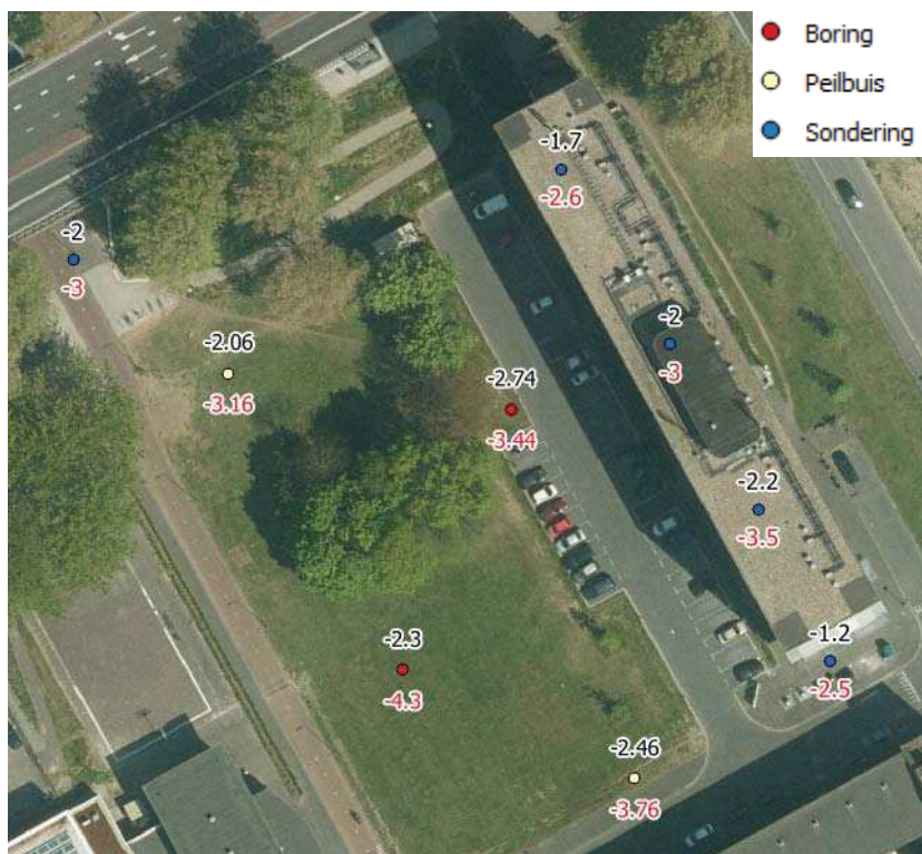
Figuur 7: Echtenstein, maaiveldhoogte (ten tijde van meting) in m NAP (zwart) en onderkant van het freatische pakket in m NAP (rood). Recente boringen en peilbuizen, en oude sonderingen van voor 1975
