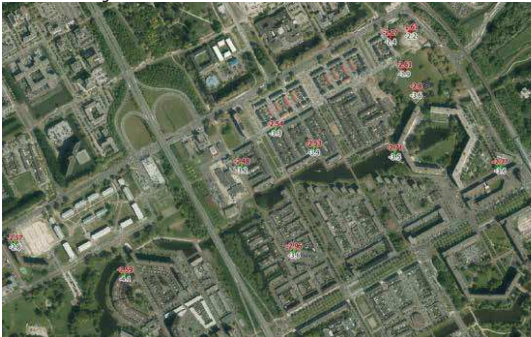
Figuur 12: Het maaiveld (roze) in m NAP en Gemiddeld Hoogste Grondwaterstanden (GHG) (wit) in m NAP in nieuw geplaatste peilbuizen (rood) en Waternet peilbuizen (groen).
