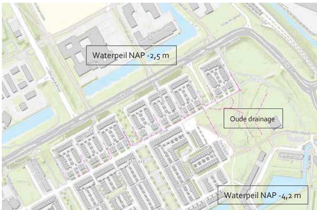
Figuur 10: Watergangen nabij plangebied en drainage (roze) in de naastgelegen nieuwbouwwijken. Van de drainage in het Egeldonk-gebied wordt aangenomen dat deze niet meer aanwezig is of niet meer functioneert.
