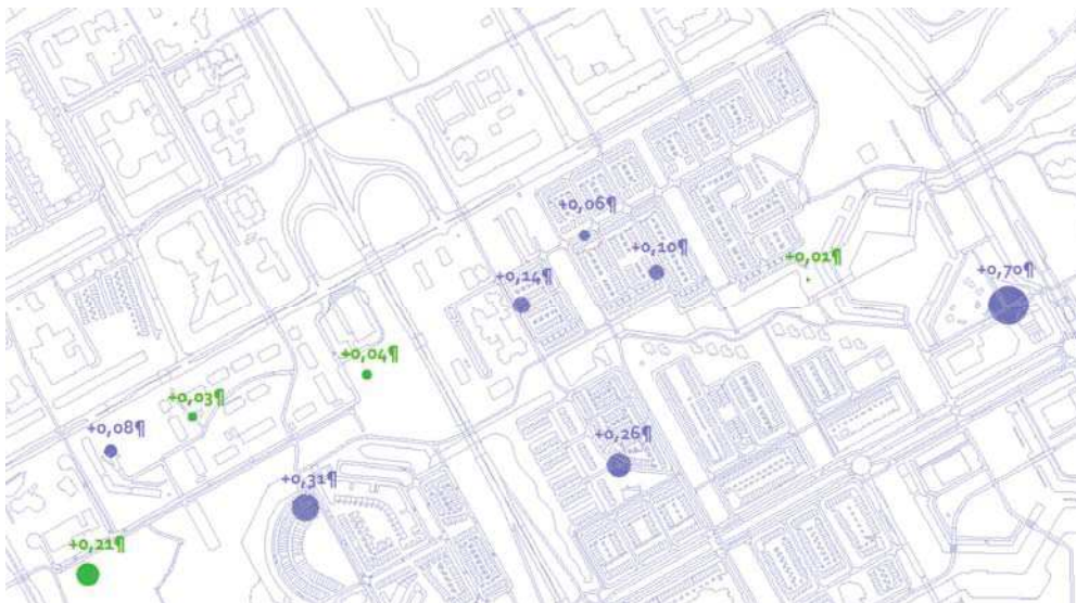
Figuur 16: IJkafwijking op 11 peilbuislocaties voor gemiddelde grondwaterstanden. De grootte van de bol en het getal (m) geeft de mate van ijkafwijking aan.
