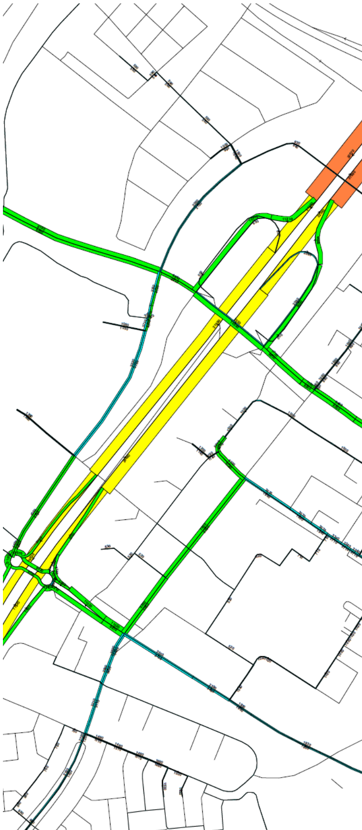
Figuur 3 intensiteit per wegvak in aantal motorvoertuigen per etmaal
