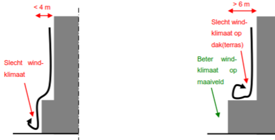
Figuur 7.1: a en b: Invloed van een setback van het gebouw op het windklimaat
