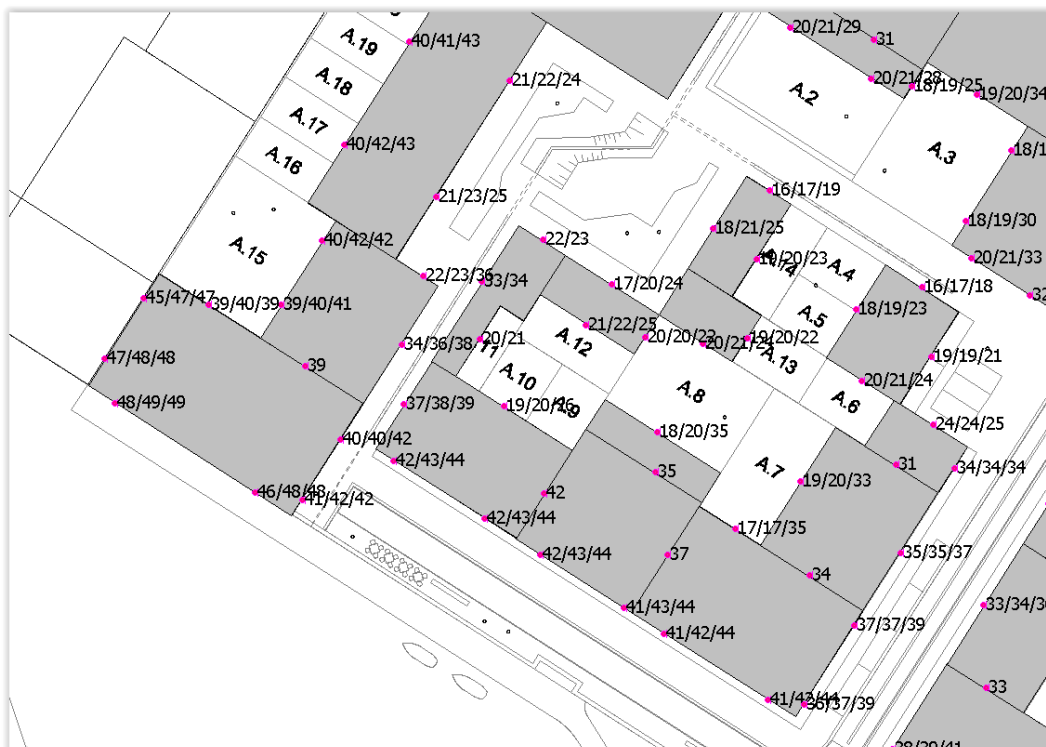
Figuur 33 Geluidbelasting vanwege de Grasweg op bouwblok A
