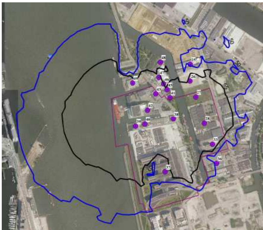
Industrielawaai na dezonering; de zwarte 55 dB(A) contour geeft weer waarbinnen zonder dove gevel woningbouw mogelijk. De Alliantie-kavel is geheel buiten deze contour.
