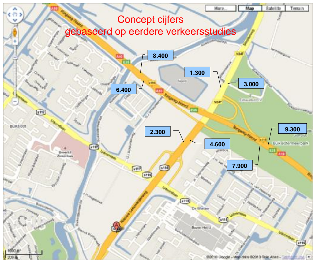
Figuur B3.2: Intensiteiten 2-uurs avondspits autonome situatie 2020
