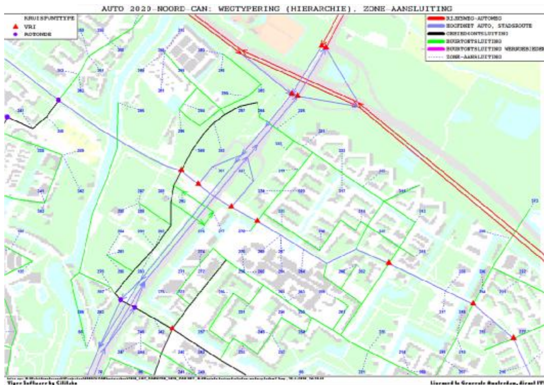
Figuur 2.3: Autonetwerk in 2020 in het CAN-gebied en de directe omgeving, overzicht zone-aansluiting, kruispuuntypes en type wegen
