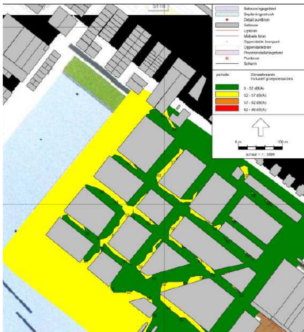
Industrielawaai Westpoort op 29 meter hoogte (hoogst belaste punt op de gevel)
