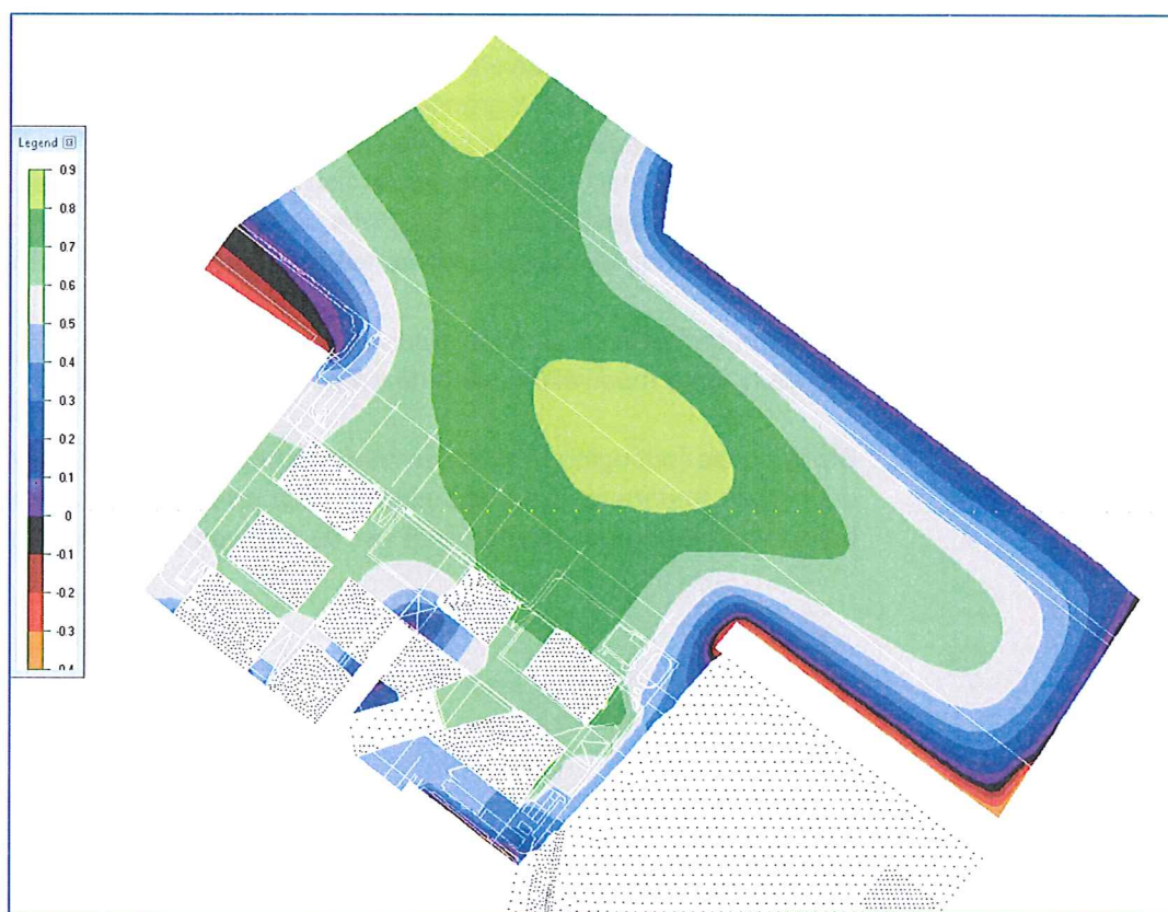
Figuur 6: Hoogste grondwaterstanden piekperiode (m NAP) bij aanleg cunetten
