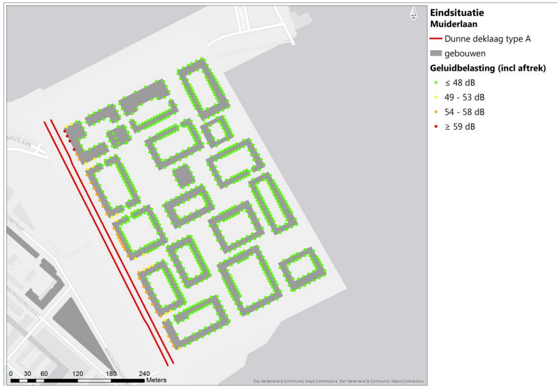
Afbeelding 4.9 Geluidbelasting ( L_{den} ) wegverkeer Muiderlaan inclusief dunne deklaag type A en inclusief aftrek artikel 110g Wgh, bij minimale gebouwhoogte op de eerste lijn
