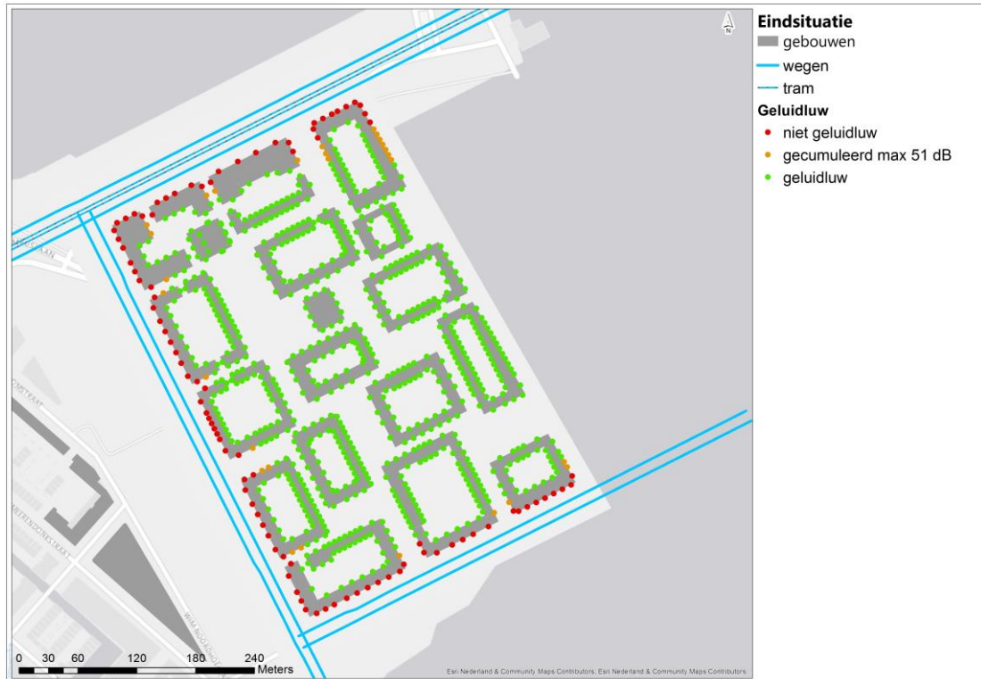
Afbeelding 4.14 Overzicht geluidluwe gevels en geveldelen
