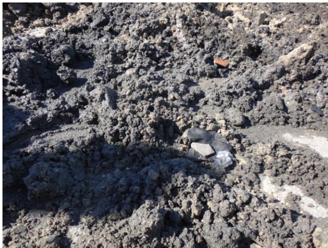
Afbeelding 5.1: Grijs en rood asbestverdacht materiaal uit asbestsleuf RH2611
