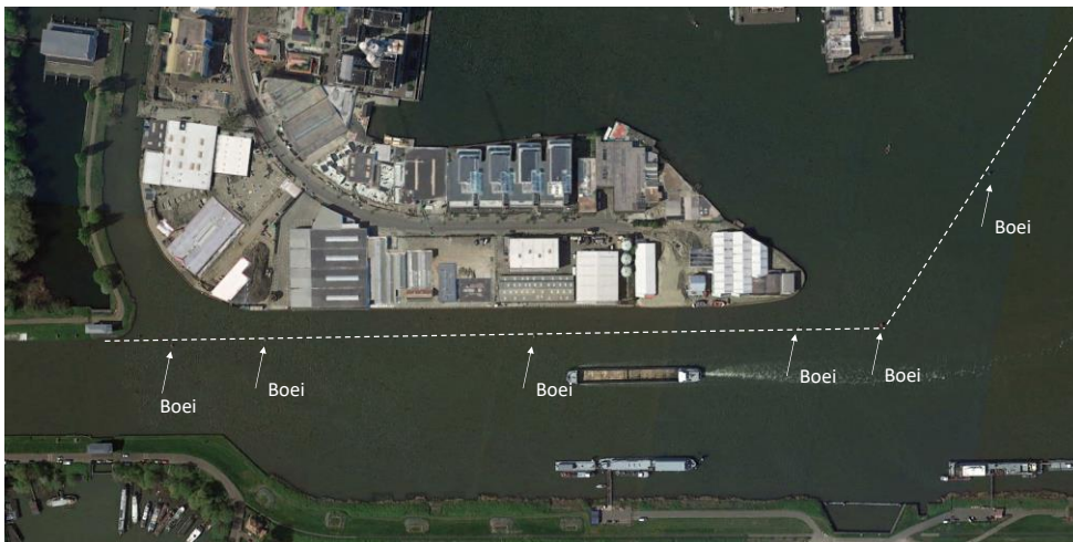
Figuur 8 De geschetste vaarweg in stippellijn, aangegeven door middel van een rij boeien, ligt op circa 20 m afstand van de huidige kade [Google Earth].
