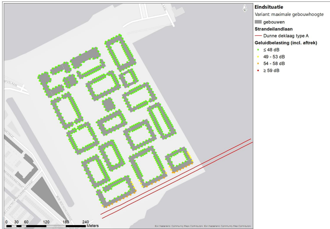
Afbeelding 4.4 Geluidbelasting ( L_{den} ) wegverkeer Strandeilandlaan inclusief dunne deklaag type A en inclusief aftrek artikel 110g Wgh, bij maximale gebouwhoogte
