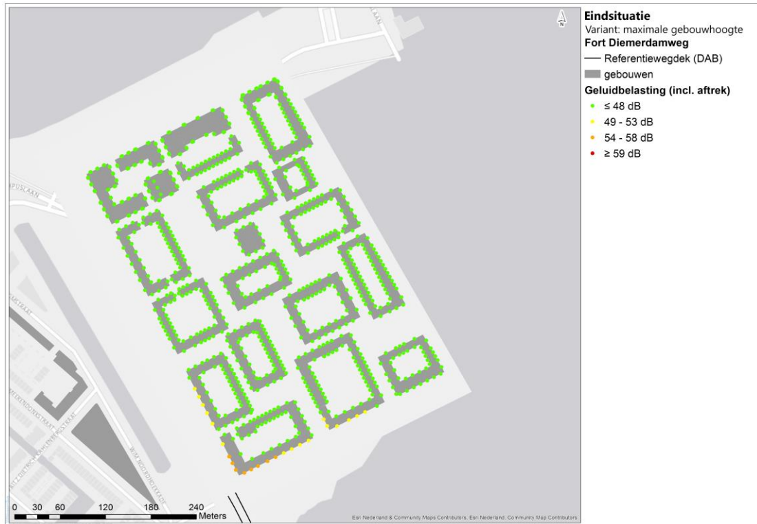
Afbeelding 4.5 Geluidbelasting ( L_{den} ) wegverkeer Fortdiemerdamweg zonder geluidreducerend asfalt, inclusief aftrek artikel 110g Wgh, bij maximale gebouwhoogte
