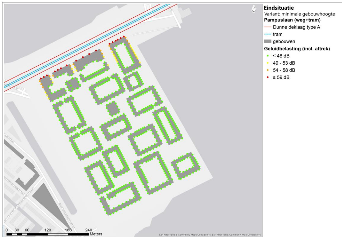
Afbeelding 4.9 Geluidbelasting ( L_{den} ) wegverkeer Pampuslaan inclusief dunne deklaag type A en inclusief aftrek artikel 110g Wgh, bij minimale gebouwhoogte op de eerste lijn
