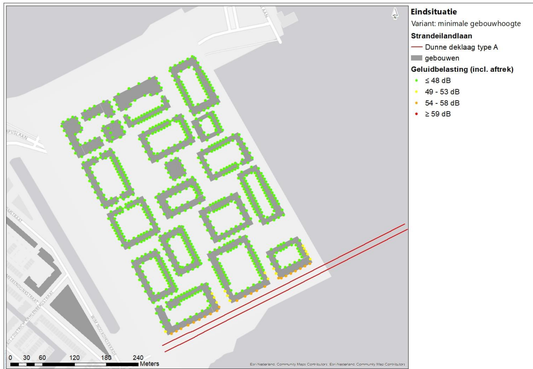
Afbeelding 4.1 Geluidbelasting ( L_{den} ) wegverkeer Strandeilandlaan inclusief dunne deklaag type A en inclusief aftrek artikel 110g Wgh, bij minimale gebouwhoogte op de eerste lijn
