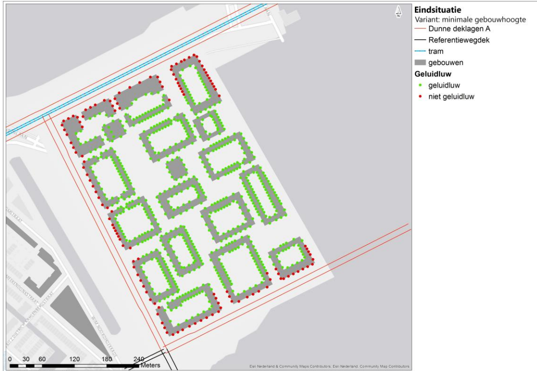
Afbeelding 4.13 Overschrijding voorkeurswaarde 48 dB, toetsing per weg, bij minimale gebouwhoogte op de eerste lijn
