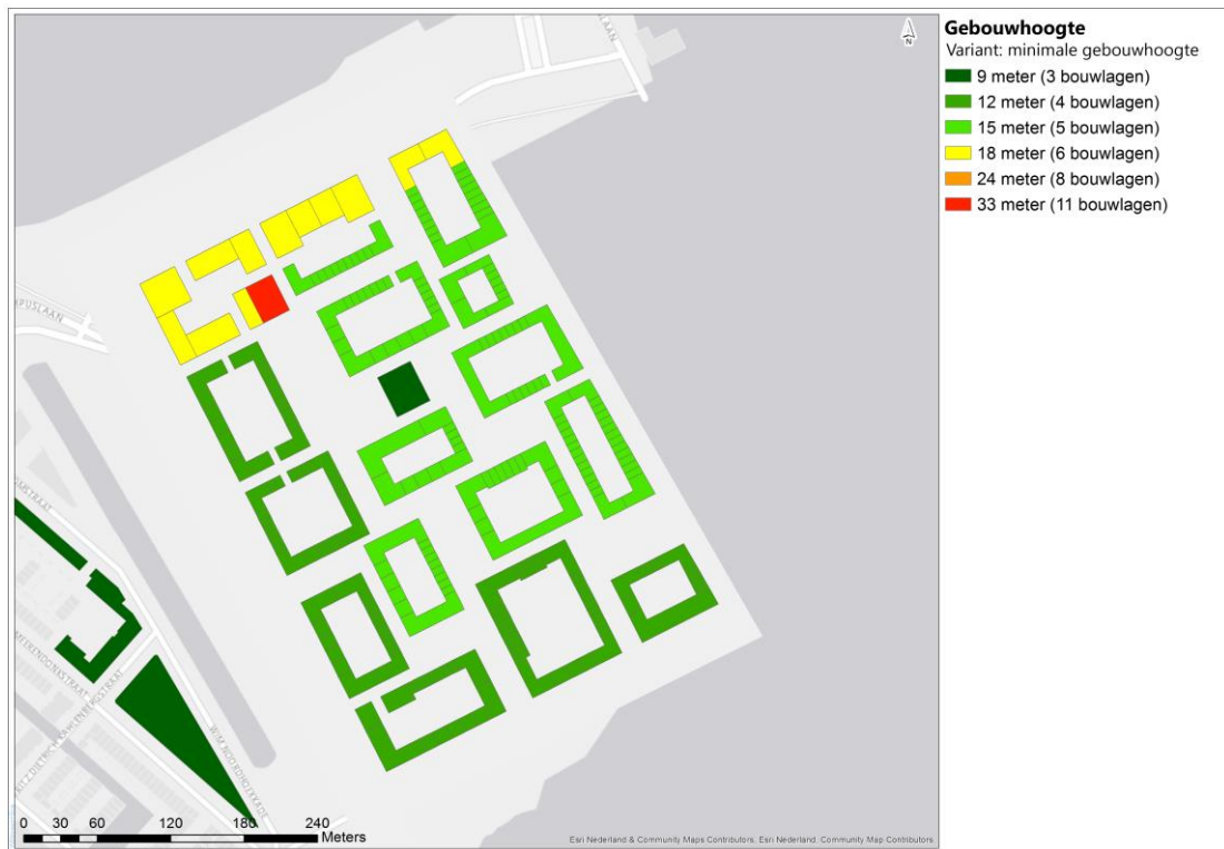
Afbeelding 3.7 Hoogte van de gebouwen in Geomilieu bij de realisatievariant 'minimale gebouwhoogte op de eerste lijn'
