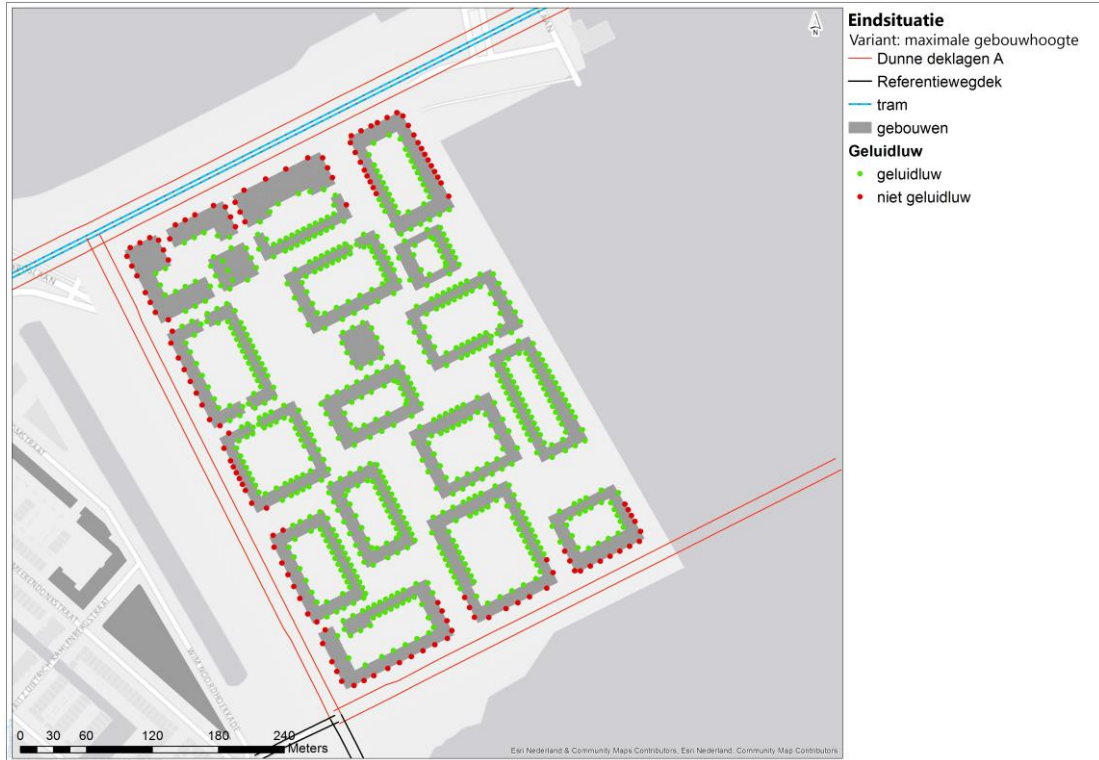
Afbeelding 4.6 Overschrijding voorkeurswaarde, toetsing per weg, bij maximale gebouwhoogte
