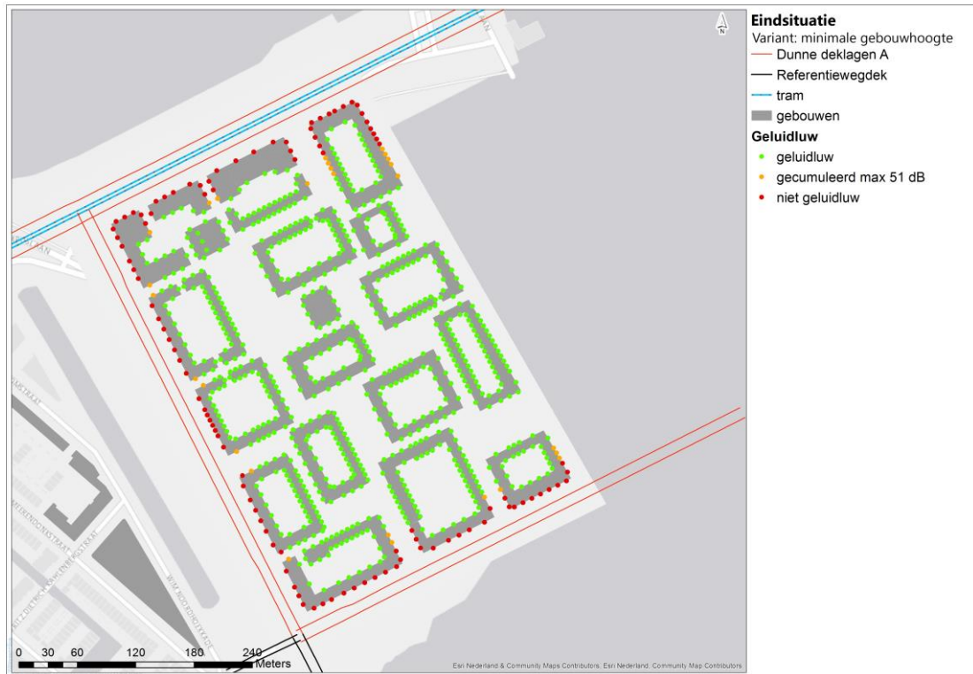
Afbeelding 4.15 Overzicht geluidluwe gevels en geveldelen
