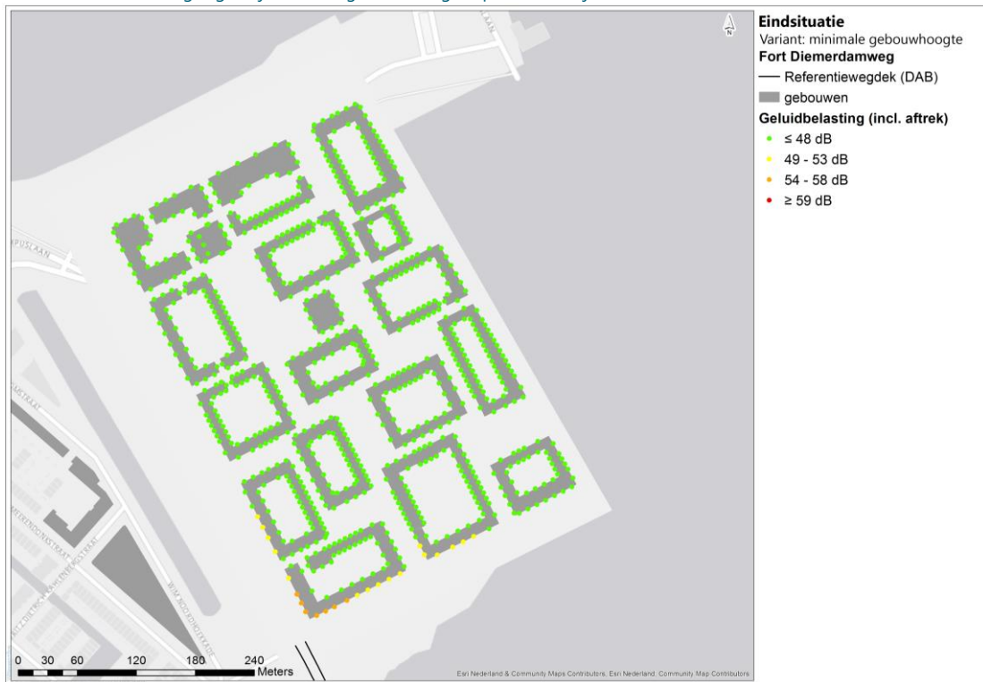
Afbeelding 4.12 Geluidbelasting (L den ) wegverkeer Fortdiemerdamweg zonder geluidreducerend asfalt, inclusief aftrek artikel 110g Wgh, bij minimale gebouwhoogte op de eerste lijn
