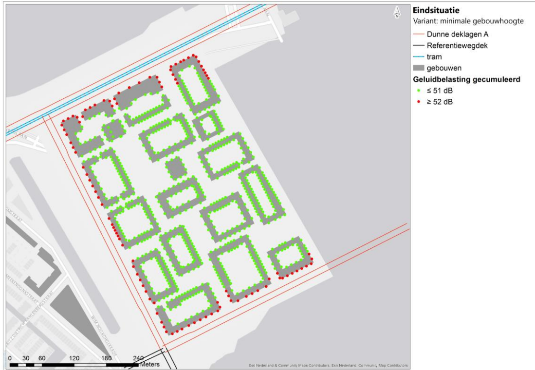
Afbeelding 4.14 Gecumuleerde geluidbelasting wegverkeer inclusief aftrek, bij minimale gebouwhoogte op de eerste lijn
