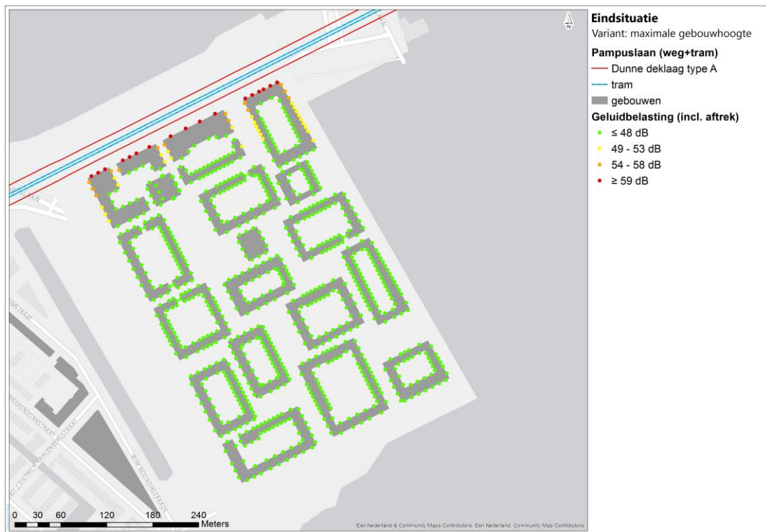
Afbeelding 4.1 Geluidbelasting ( L_{den} ) wegverkeer Pampuslaan inclusief dunne deklaag type A en inclusief aftrek artikel 110g Wgh, bij maximale gebouwhoogte
