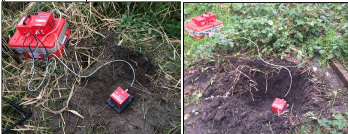
Figuur 3.3: Trillingssensor in kuil op meetpunt 01 (links) en meetpunt 02 (rechts)
