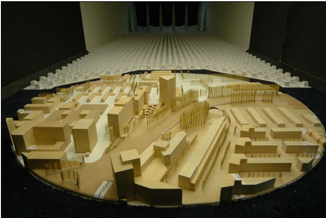
Figuur 1 : Maquette in de windtunnel.
