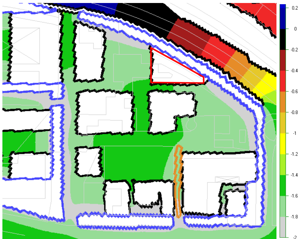
Figuur 9: Berekende maatgevend hoge grondwaterstand in 2050 met geschakelde kelders. Wit weergegeven vlakken betreffen: kelders (zwart omlijnd), oppervlaktewater (blauw omlijnd). Drainage is aangeven met een oranje lijn en de ondergrond is de GBKA van 2015.
