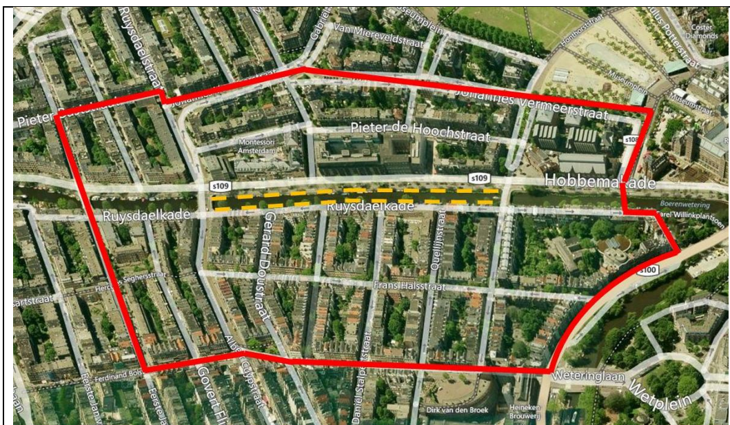
Figuur 2: overzicht begrenzing gebied voor CFD-berekening. De eerste simulaties zijn uitgevoerd met een gebied ter grootte van 800 x 600 x 60 m. Na deze gevoeligheidsanalyse is de grootte van het uiteindelijk te simuleren gebied bepaald op 475 x 300 x 60 m.
