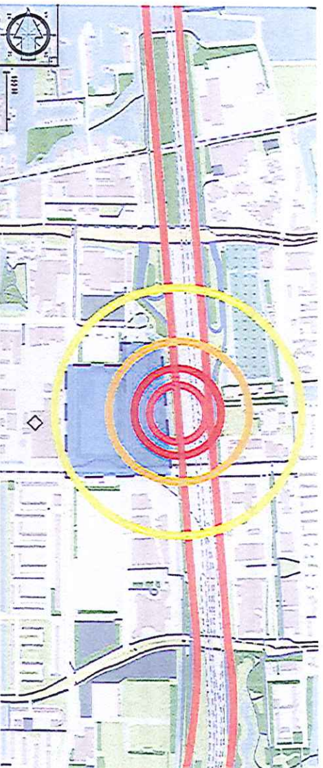
Figuur 2. Schematische weergaven van de effectgebieden na een BLEVE van een tankwagen LPG
