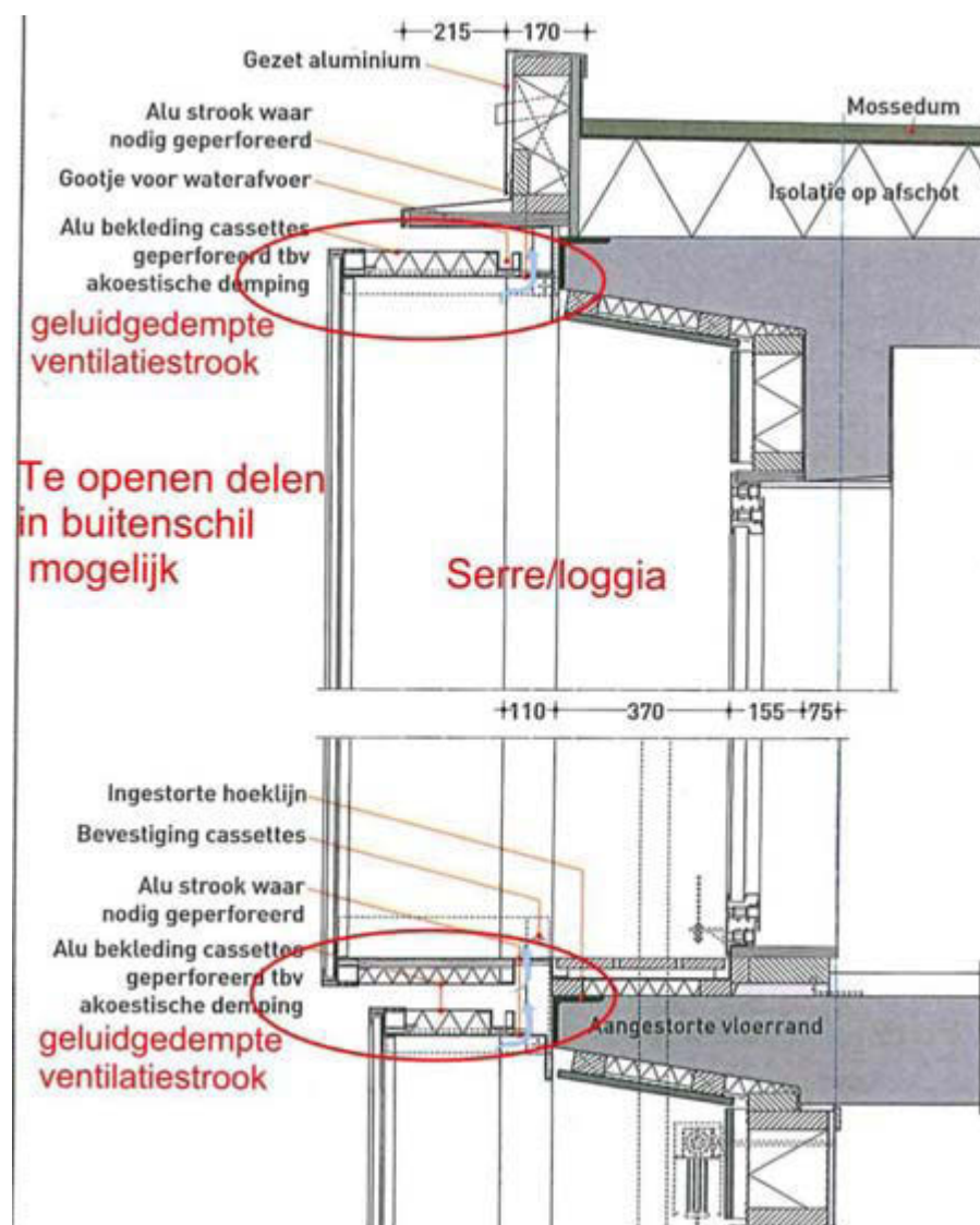
Principe serre/loggia met geluidgedempte ventilatiestroken
