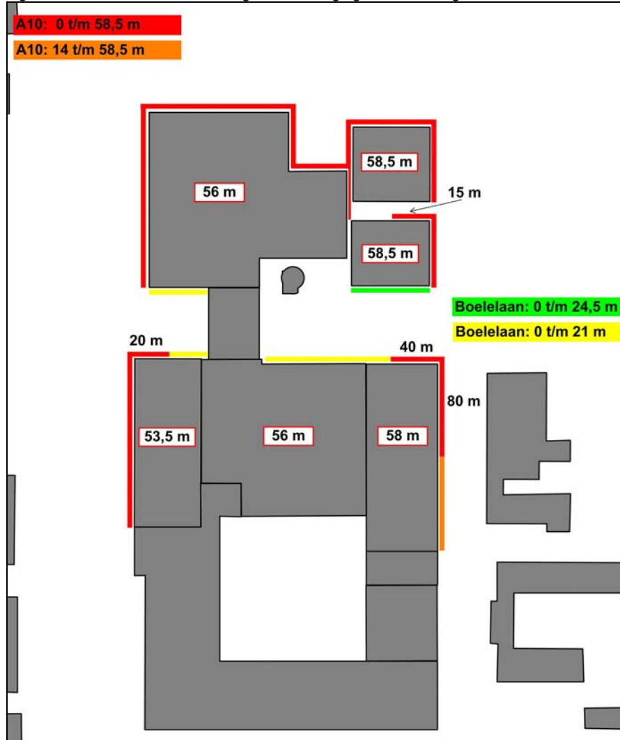
Figuur 5-1. Overzicht vereiste dove gevels vanwege geluid afkomstig van de A10 en De Boelelaan.
