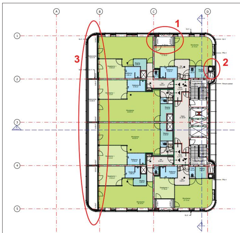
Figuur 7.1: Overzicht toe te passen geluidwerende oplossingen.
