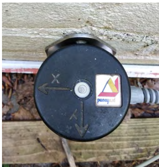
Figuren 4 en 5: positie van de meetapparatuur en de geofoon.
