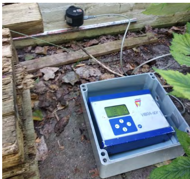
Figuren 4 en 5: positie van de meetapparatuur en de geofoon.
