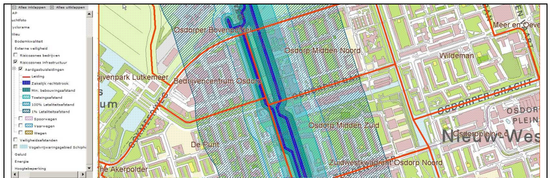
Figuur 2: Bestemmingsplangebied Osdorp Midden Noord met risico contouren van de hoge-druk aardgasleidingen
