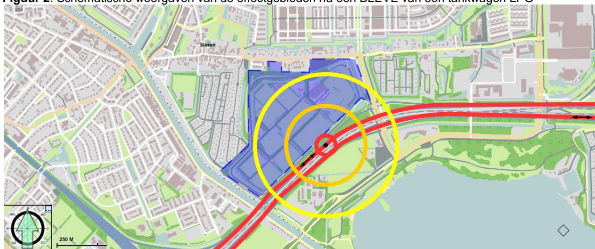
Figuur 2. Schematische weergaven van de effectgebieden na een BLEVE van een tankwagen LPG
